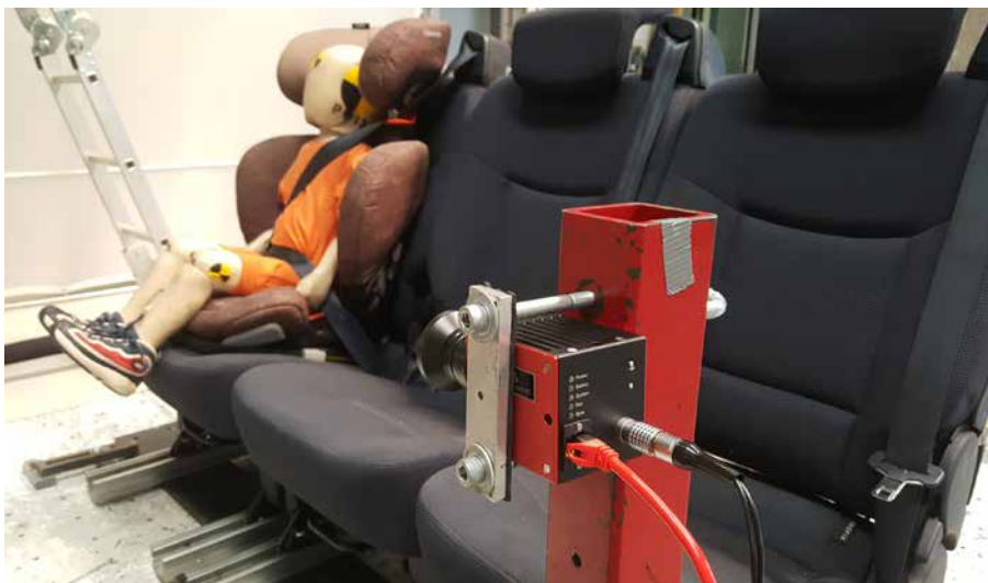
Abb: AOS High Speed Kamera montiert auf einem Simulator zur Sicherheitsprüfung von Kindersitzen während des Aufpralls. Die Kamera zeichnet den Vorgang mit 1000 Bilder/Sekunde auf.
